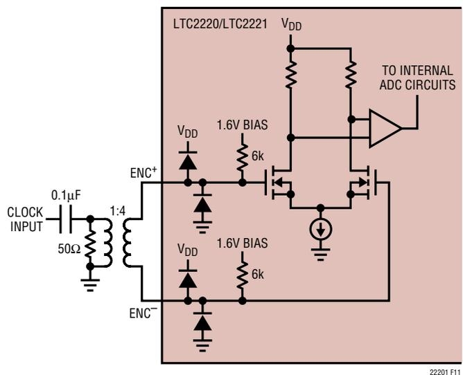
Figure 11. Transformer Driven ENC<sup>+</sup>/ENC<sup>-</sup>
