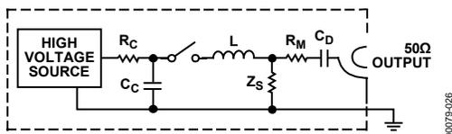
Figure 26. EFT Generator
