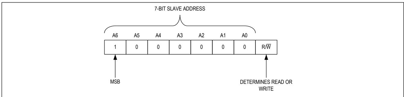
Figure 8. DS2485 I<sup>2</sup>C Slave Address
