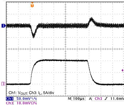
Figure 5. PWM Load Transient (0 to 10A)
