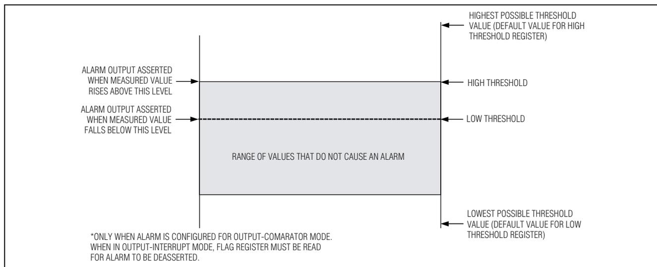
Figure 9. Hysteresis-Threshold-Mode Diagram
