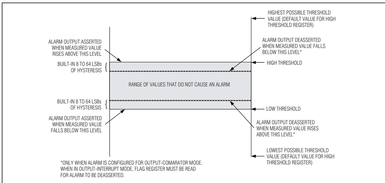
Figure 7. Window-Threshold-Mode Diagram
