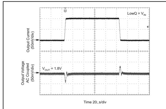
**FIGURE 2-12:** Load Transient PWM Mode.
