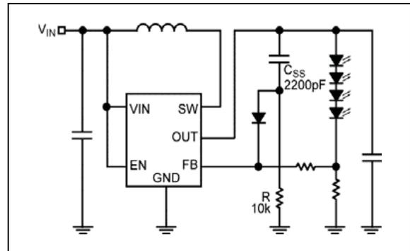
**FIGURE 4-4:** Soft-Start Circuit.
