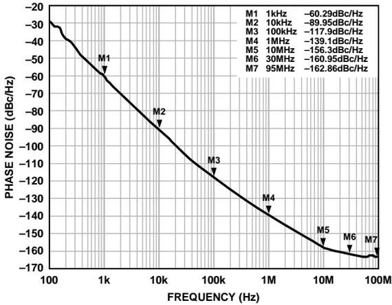
Figure 7. Open-Loop VCO Phase Noise, 4.0 GHz, VCC\_VCO = 5 V
