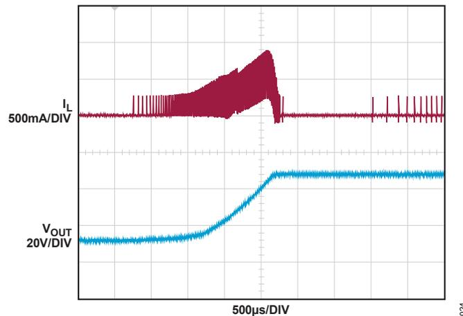
**Figure 25. Soft-Start Waveforms**
