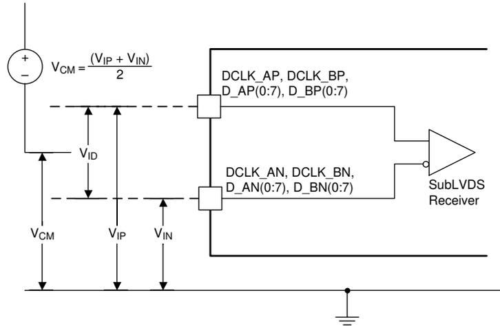
**Figure 6-9. SubLVDS Voltage Parameters**
