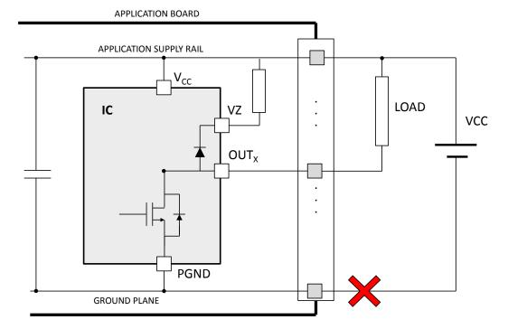
Figure 11. GND wire break
