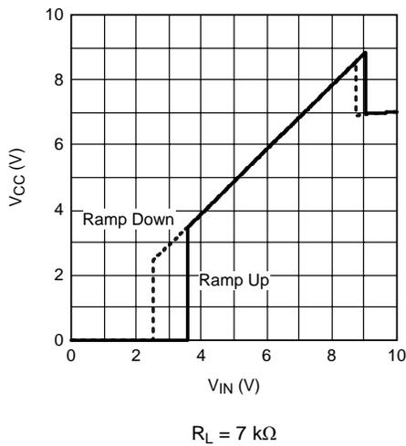
Figure 5. V<sub>CC</sub> vs V<sub>IN</sub>
