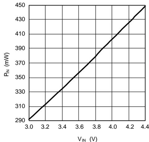
**Figure 28.  $P_{IN}$  vs  $V_{IN}$**
