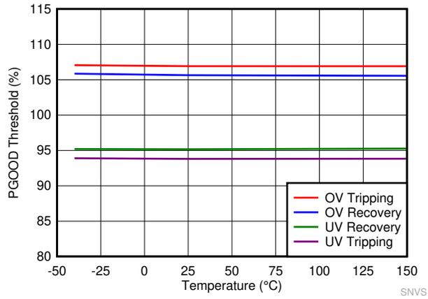
Figure 7-7. PGOOD Thresholds
