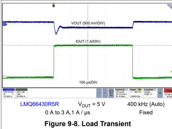
Figure 9-8. Load Transient
