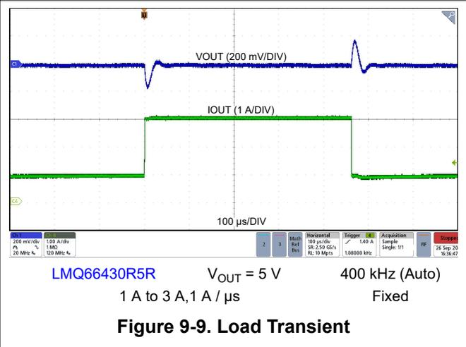
Figure 9-9. Load Transient
