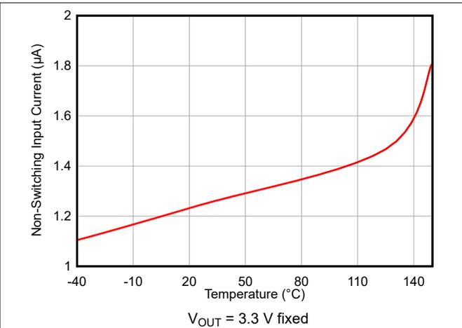
**Figure 7-2. Nonswitching Input Current ( $I_{QVIN(nonsw)}$ ) Versus Temperature**
