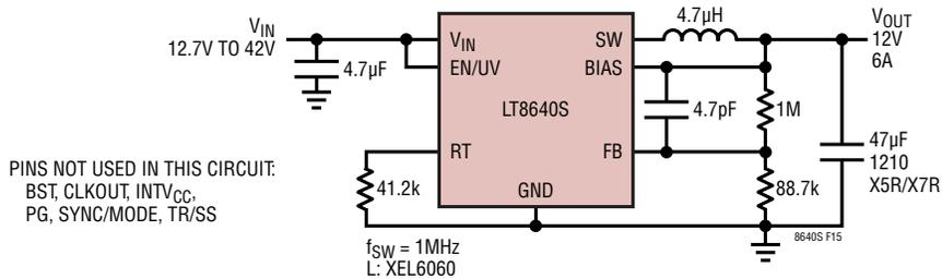
Figure 15. 12V, 6A Step-Down Converter
