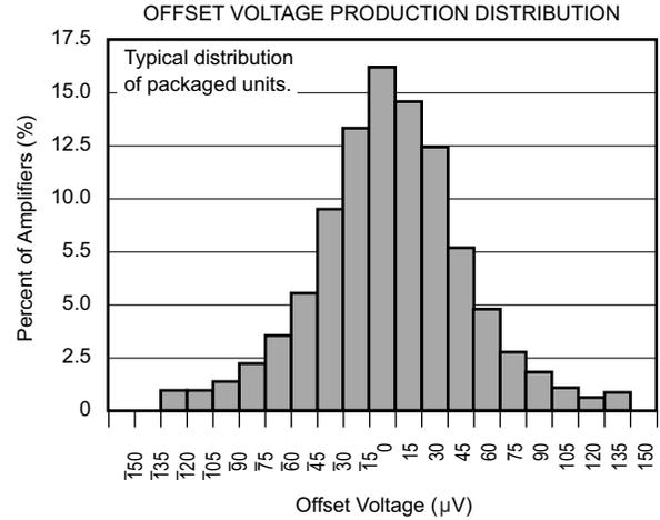
**Figure 6-10. Offset Voltage Production Distribution**
