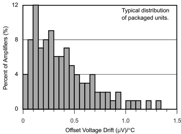
**Figure 6-11. Offset Voltage Drift Production Distribution**
