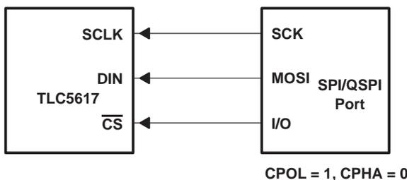
**Figure 24. SPI/QSPI Connection**
