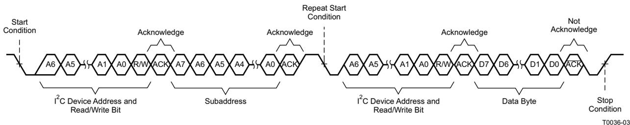
Figure 30. Single-Byte Read Transfer
