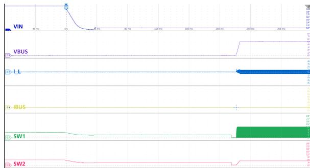
$V_{IN} 20\text{ V} \rightarrow 12\text{ V}$
