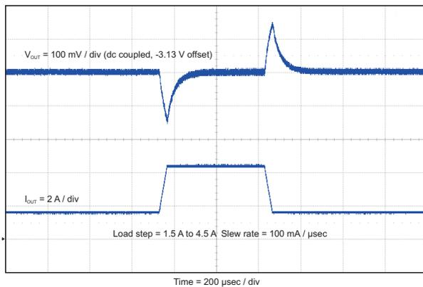
Figure 30. Load Transient
