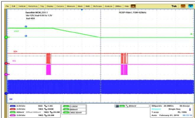
$V_{IN}=12\text{ V}$   $V_{OUT}=1.2\text{ V to }0.6\text{ V}$
