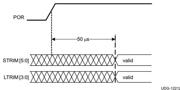
Figure 27. Power-ON OTP ROM Read Timing
