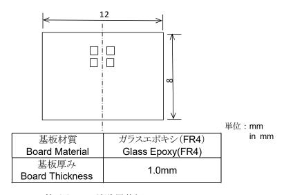
第6図 試験用基板 Figure6. Test Board
