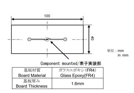
第5図 たわみ試験用基板
