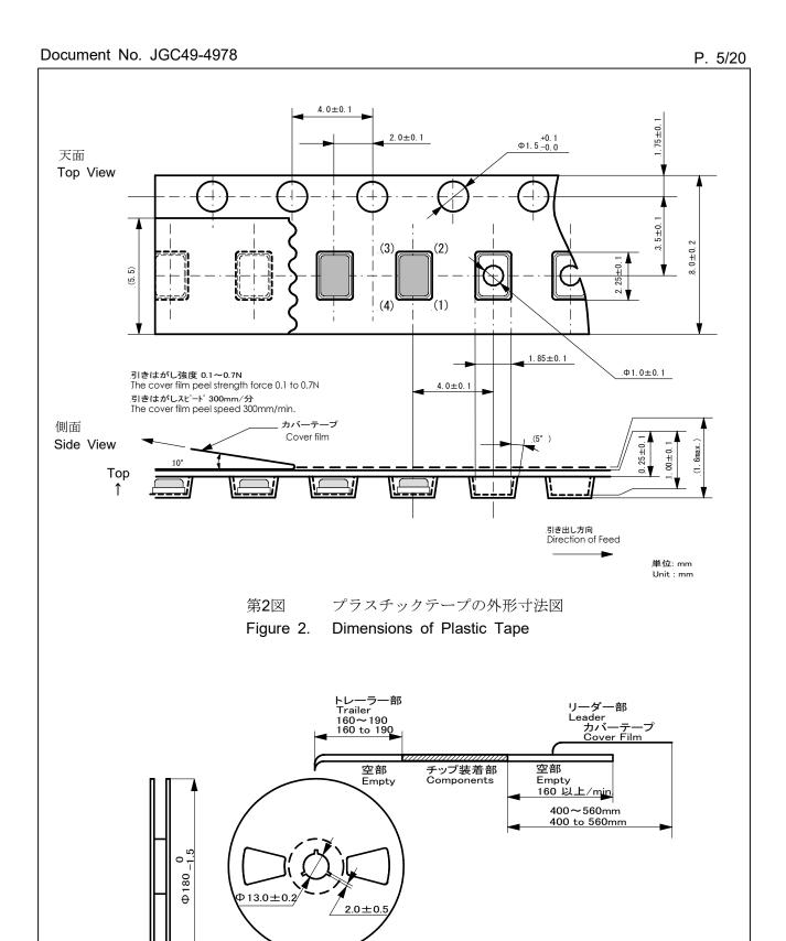
第3図 プラスチックリールの外形寸法図
