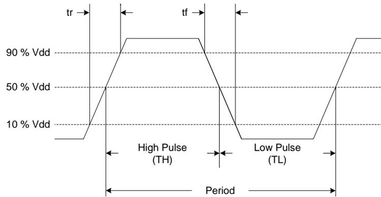
Figure 5. LVC MOS Waveform Diagram<sup>[13]</sup>
