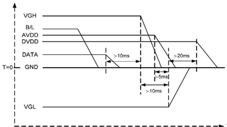
$\text{B/L} \rightarrow \text{Data} \rightarrow V_{GH} \rightarrow V_{GL} \rightarrow V_{DD}$
