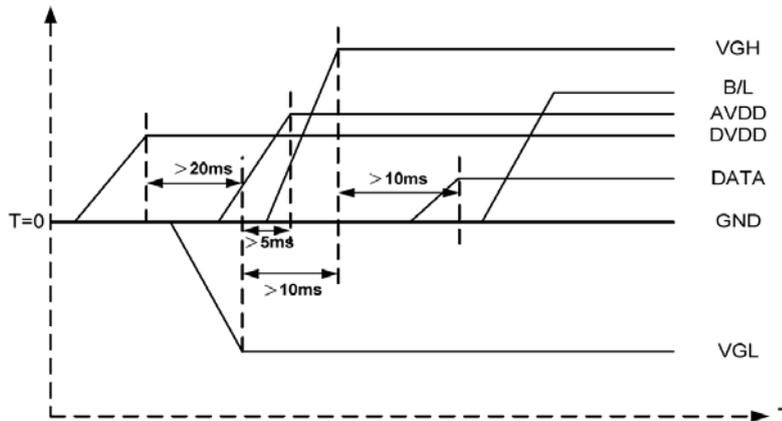
$V_{DD} \rightarrow V_{GL} \rightarrow V_{GH} \rightarrow \text{Data} \rightarrow \text{B/L}$
