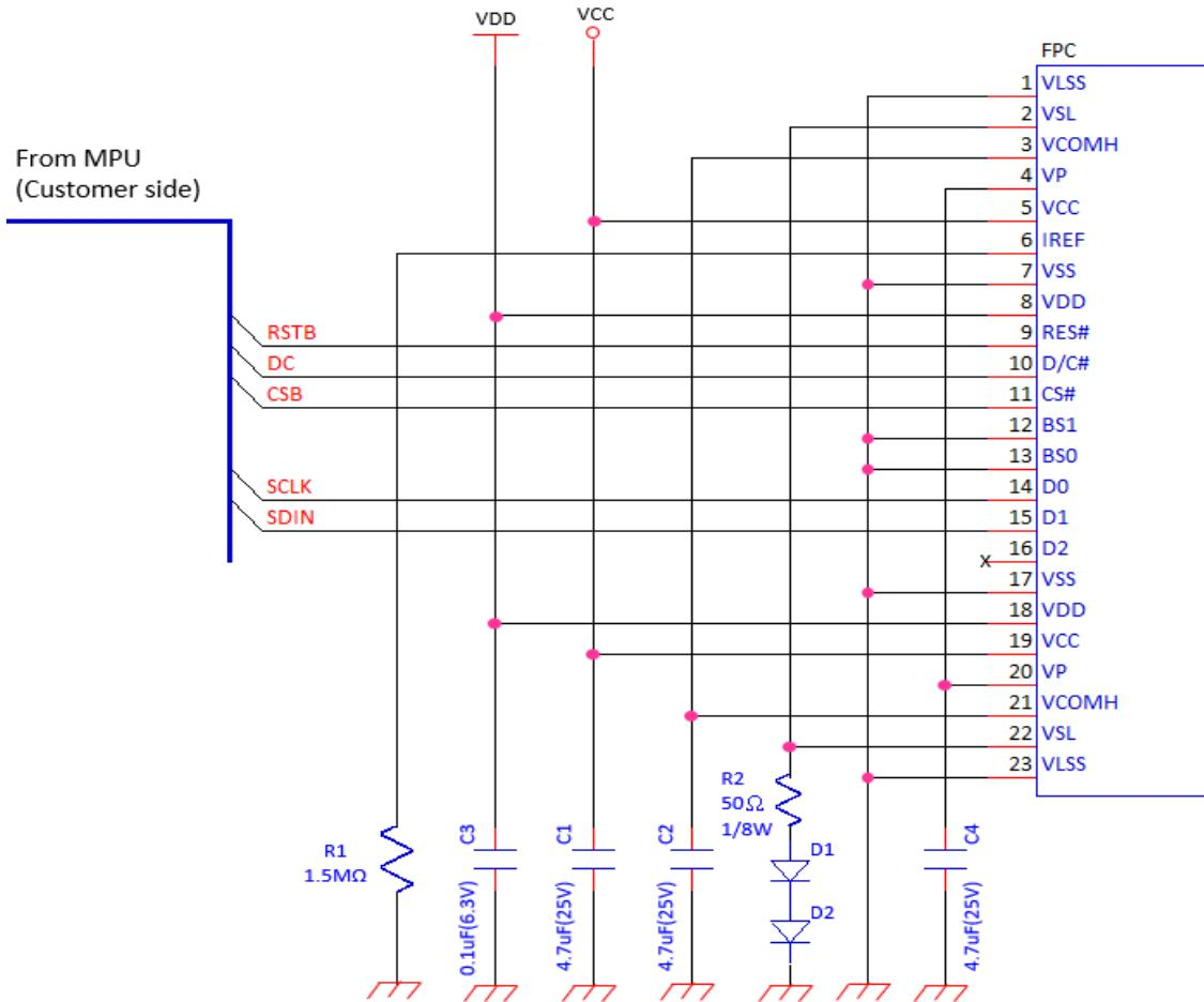
12-2-2) 3線シリアルインターフェースでの推奨回路 Recommended Circuit for 3-wire Serial Interface
