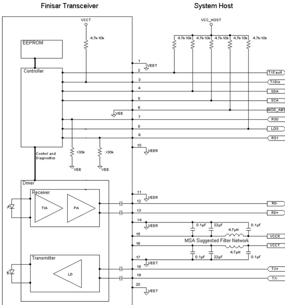
Figure 5. Host-Module Interface
