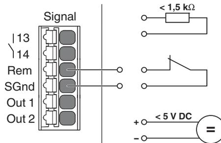
Figure 24 External wiring versions, enable SLEEP MODE
