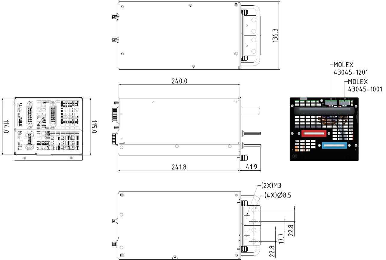
Note : Weight : 12kW 300V module (73-938-0300) – 5.1Kg
