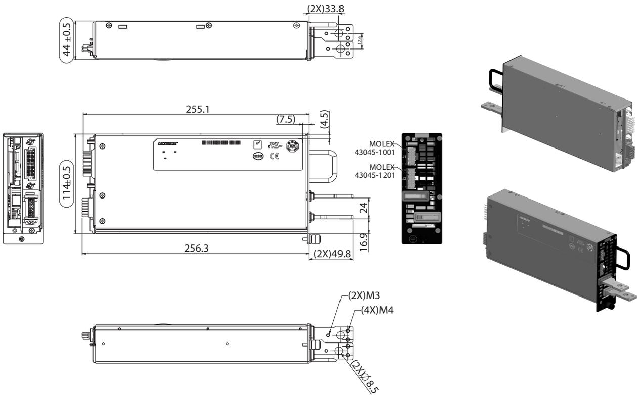
Note : Weight : 3kW module 12V - 32V - 2.2Kg
