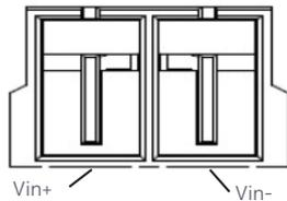
OUTPUT CONNECTOR PIN CONFIGURATION
