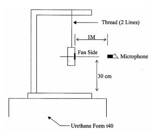
1 METER FROM MICROPHONE TO FAN INTAKE
