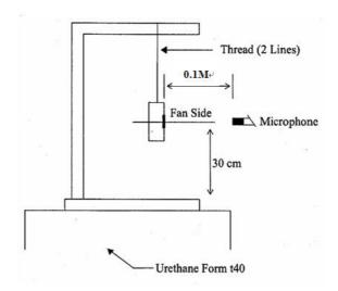
0.1 METER FROM MICROPHONE TO FAN INTAKE
