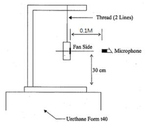
0.1 METER FROM MICROPHONE TO FAN INTAKE
