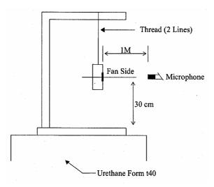
1 METER FROM MICROPHONE TO FAN INTAKE
