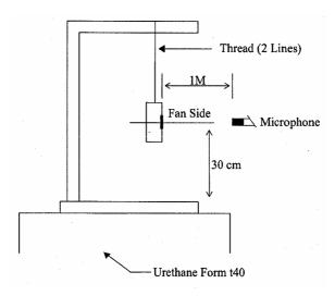
1 METER FROM MICROPHONE TO FAN INTAKE
