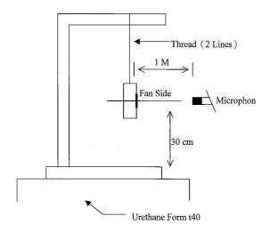
1 METER FROM MICROPHONE TO FAN INTAKE
