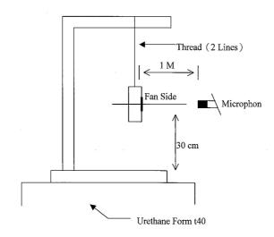
1 METER FROM MICROPHONE TO FAN INTAKE
