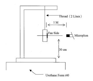
1 METER FROM MICROPHONE TO FAN INTAKE
