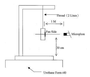
1 METER FROM MICROPHONE TO FAN INTAKE
