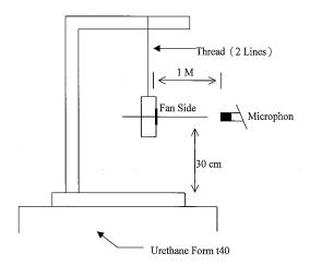
1 METER FROM MICROPHONE TO FAN INTAKE
