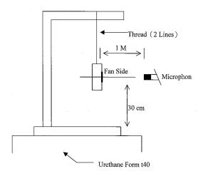
1 METER FROM MICROPHONE TO FAN INTAKE
