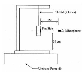
1 METER FROM MICROPHONE TO FAN INTAKE
