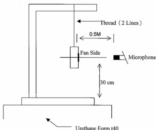
0.5 METER FROM MICROPHONE TO FAN INTAKE
