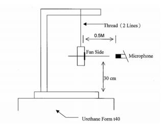
0.5 METER FROM MICROPHONE TO FAN INTAKE
