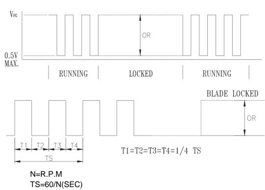
\*VOLTAGE LEVEL AFTER BLADE LOCKED
