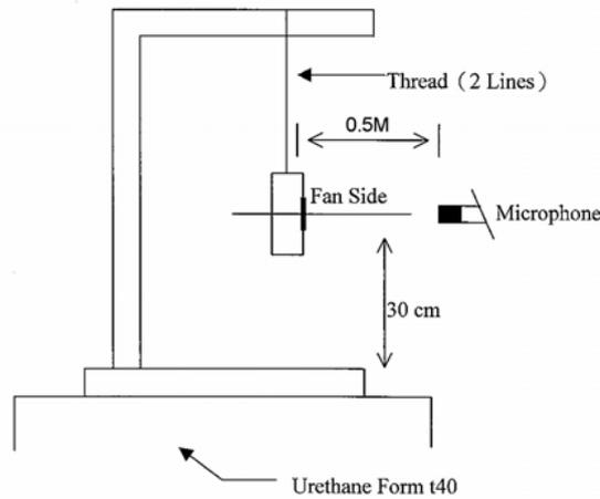
0.5 METER FROM MICROPHONE TO FAN INTAKE
