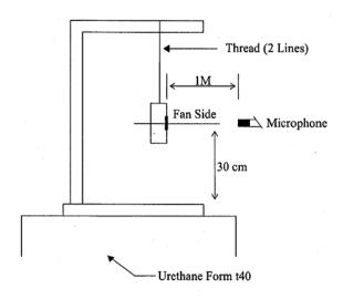
1 METER FROM MICROPHONE TO FAN INTAKE
