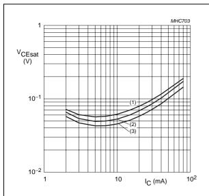
Transistor TR2;  $I_C/I_B = 20$ .
