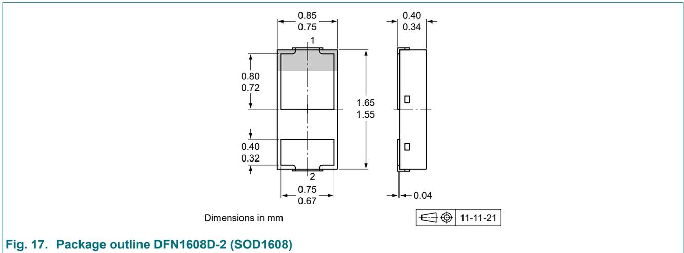
Fig. 17. Package outline DFN1608D-2 (SOD1608)
